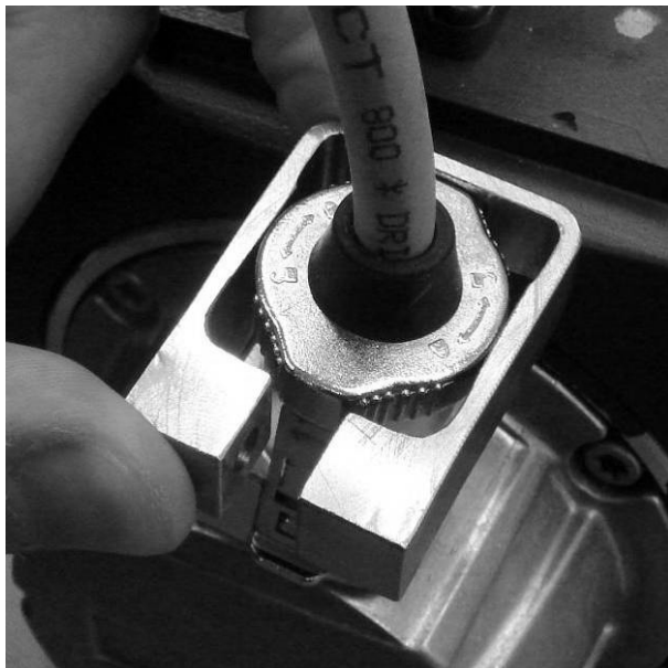
Bild 2: Als nächstes ist der Löseschutz über die Verriegelung zu schieben.
